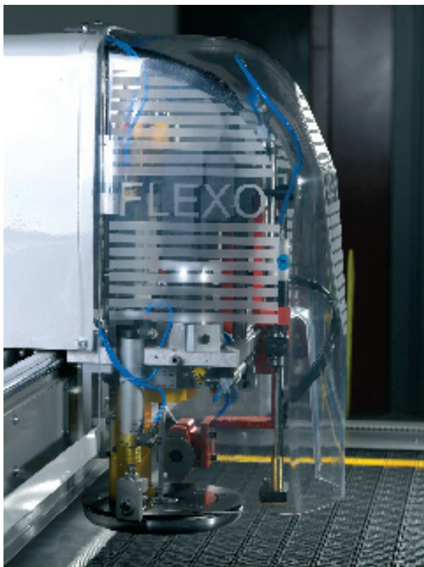
System inteligentnego noża zapewnia jego centralne i prostopadłe położenie podczas rozkroju, kluczowe dla jakości kroju.
